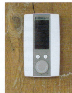
Thermostat EnOcean avec dispositif piézoélectrique. Ce dispositif mécanique produit de l'électricité nécessaire au thermostat.
